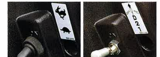
変速切り替えスイッチ (左: FD100~FD135, 右: FD150A)
